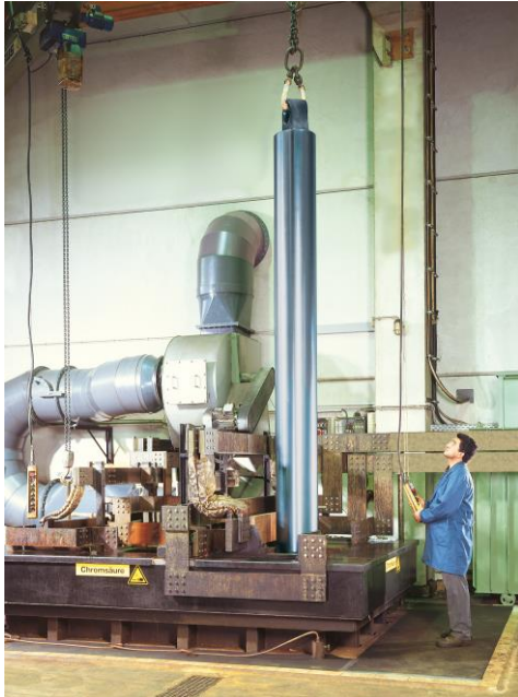
Hartverchromen eines Hydraulikkolbens, Abmessung Ø 400 x 4800 mm
